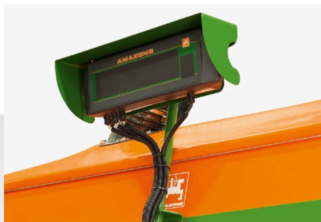
Technique de pesée pour trémie d'engrais arrière de l'ED 6000-2C Super
